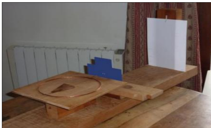
Au premier plan l'émetteur Têtard suivi d'un écran de plastique percé de deux petits trous, en bleu, et au fond la feuille A4 verticale qui reçoit l'empreinte de l'émission
